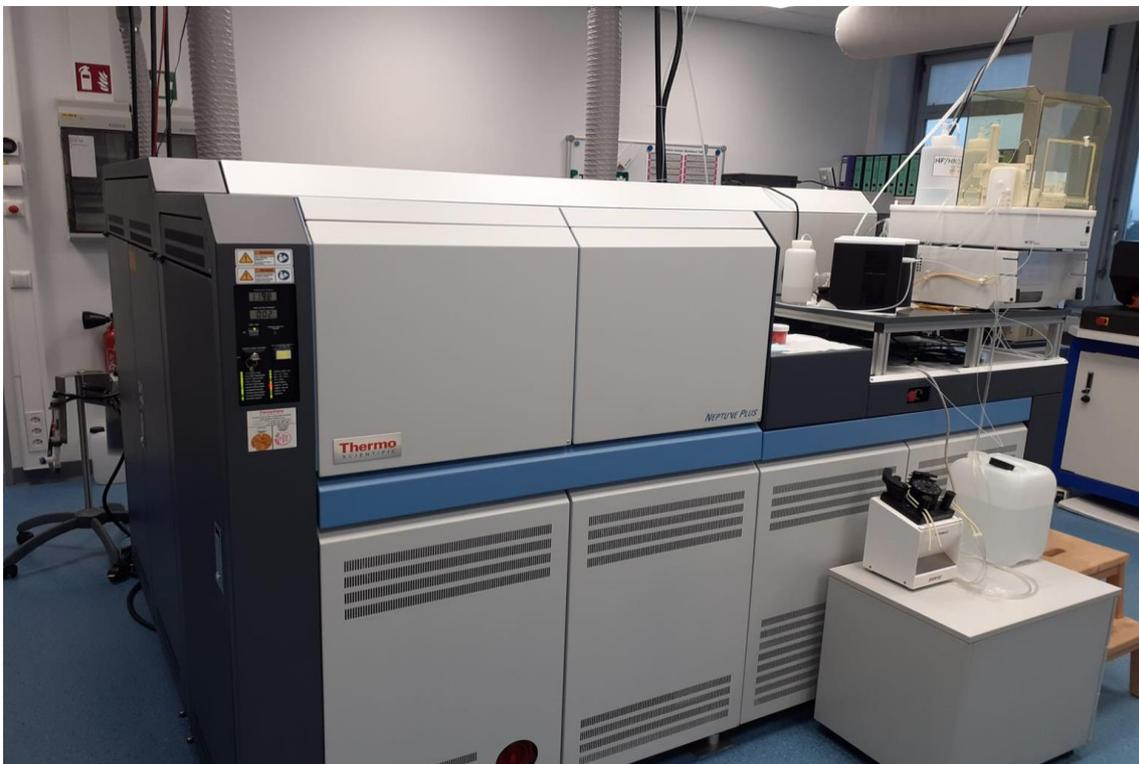
*Abbildung 9: MC-ICP-MS von Thermo Fischer Scientific im geowissenschaftlichen Institut an der JGU Mainz*
