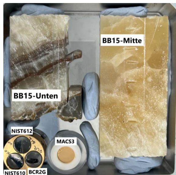
Abbildung 16: Probenkammer Messung 2; BB-15–Mitte, –Unten, Standards (NIST610, NIST612, BCR2G, MACS-3).
