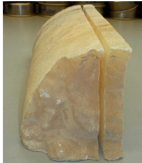
Abbildung 13: Zerteilung des Bohrkerns; (BB-15 – Science@Bleßberghöhle (pik-potsdam.de)).
